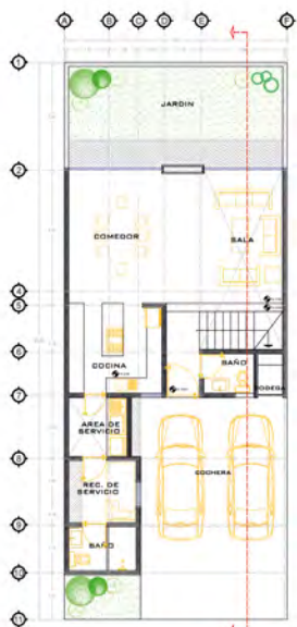
PLANTA ARQUITECTONICA BAJA ESCALA: 1:100
