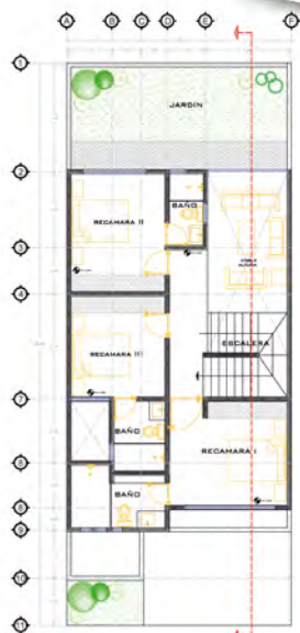
PLANTA ARQUITECTONICA ALTA ESCALA: 1:100
