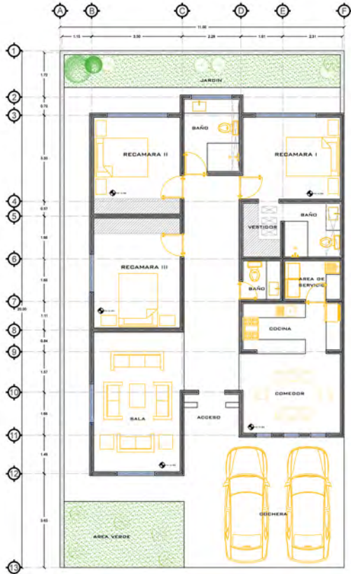
PB PLANTA ARQUITECTONICA BAJA ESCALA: 1:100
